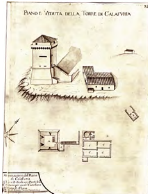
Atlante Warren: pianta e veduta assonometrica della torre e suoi annessi (1749)
