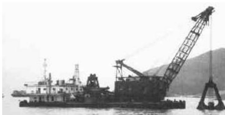
Figura 13 Tipologia di draga meccanica: benna mordente ( www.osservatoriomare.lazio.it )
