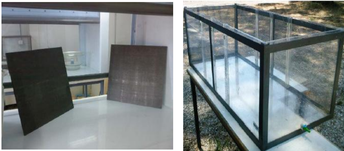
Figura 29. Impianto sperimentale per la separazione elettrocinetica dei fanghi di dragaggio della Rada di Augusta
