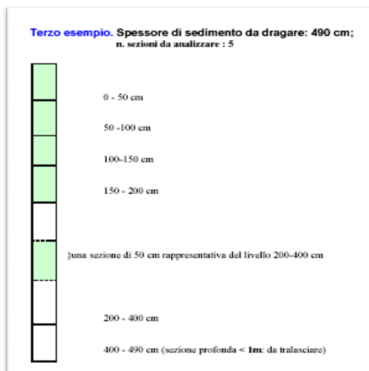
Figura 6: esempi di sezioni da prelevare in funzione dello spessore di sedimento da analizzare.
